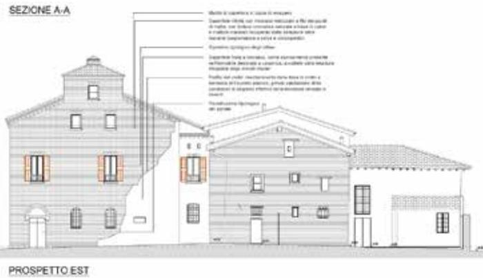
Complesso della Canonica Vecchia: prospetto est con l'indicazione della porzione ricostruita e la rettificazione di alcune aperture per utilizzare compiutamente anche la torretta.
